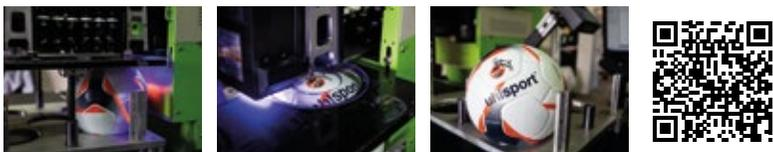
Le logo est imprimé directement sur la surface du ballon à l'aide d'une imprimante à jet d'encre UV.
